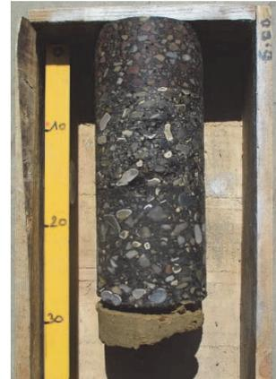
Figure 7. Anomalie dans la couche supérieure de GB, décollement de la couche de forme.
