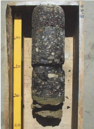
Figure 6. Décollement entre couches de GB, anomalie dans la couche inférieure de GB, feuilletage au niveau de la couche de forme.
